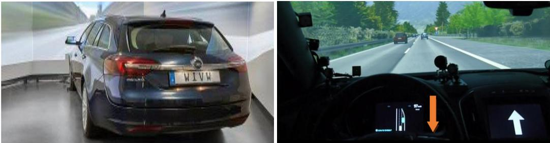
Abbildung 2: Mockup und Sichtsystem des statischen High-End-Simulators (links) und beispielhafte Fahrersicht inkl. Lenkradbutton (durch Pfeil hervorgehoben) zur Bestätigung einer Kooperationsanfrage (rechts).
