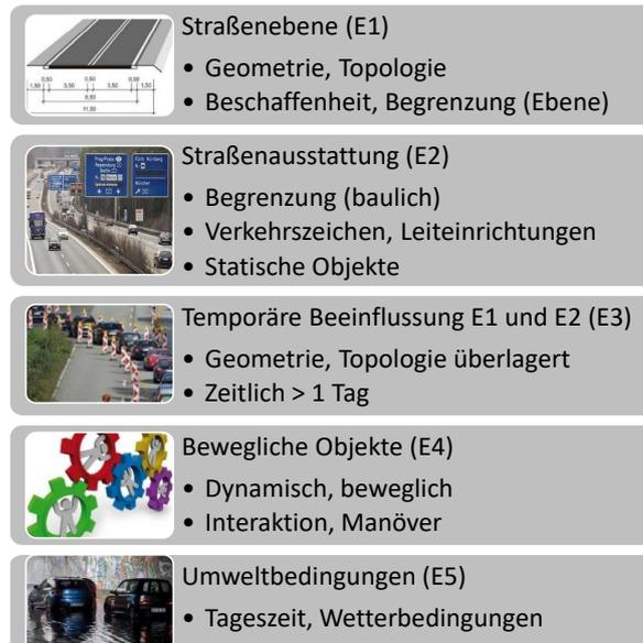
Abbildung 2: 5-Ebenen-Modell zur Strukturierung des Wissens über Szenarien basierend auf Schuldt [2]
