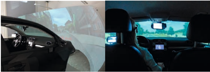
Abbildung 1: Außenansicht des Fahrsimulators (links) und Versuchsaufbau (rechts).
