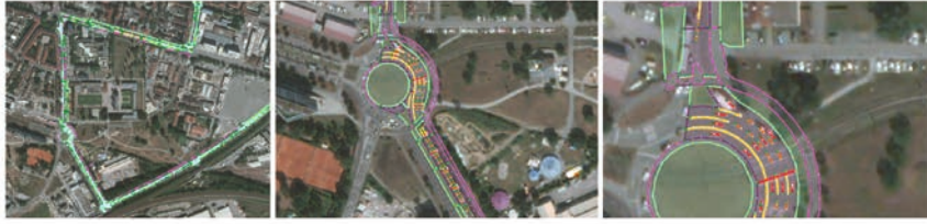
(a) Beispiel für eine der verwendeten HD-Karten in der Vogelperspektive. Der Kartenabschnitt zeigt eine Kreuzung in Karlsruhe und ist in drei verschiedenen Zoom-Stufen dargestellt. Für die Luft- und Satellitenbilder wurde Esri World Imagery [1] verwendet.
