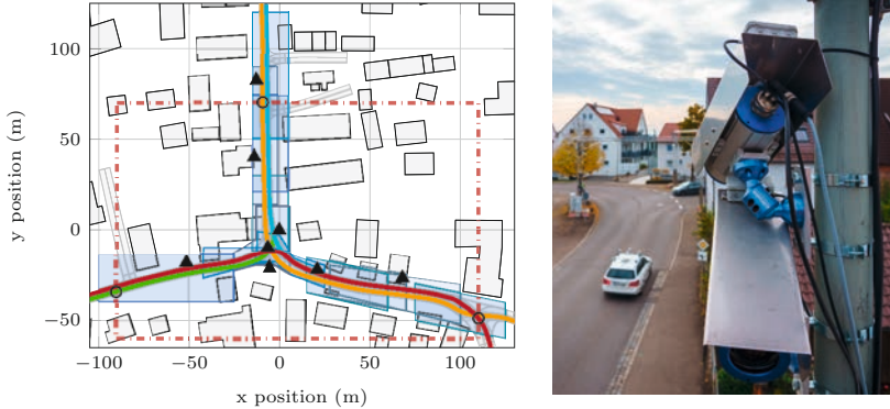
Abbildung 3: Simuliertes Verkehrsszenario an der Infrastrukturanlage in Ulm-Lehr mit sieben Fahrzeugen (farbige Linienzüge), 14 Sensoren (deren Sichtbereich blau dargestellt sind), allen Sensormasten (markiert durch \blacktriangle ), den statischen Geburtsorten (markiert durch \circ ) und dem ausgewerteten Bereich (rot gestrichelter Bereich) [25,26].
