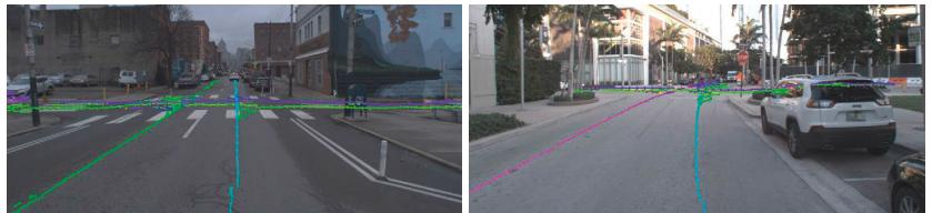
**Abbildung 4:** Ergebnisse der Mittellinienschätzung auf dem Argoverse-Datensatz [21]. Die Farben zeigen hier die Orientierung der Liniensegmente und somit die Fahrtrichtung der Linien an. Besonders für Mittellinien ist es wichtig, dass YOLinO mehrere Linien pro Zelle schätzen und somit Kreuzungen repräsentieren kann.
