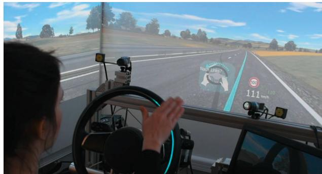
Abbildung 4: Manöverbasierte Interaktion für Vorreiter im IAW-Fahrtsimulator. Das Vorreiter-Lenkrad von Valeo gibt während einer Gesteneingabe visuelles Feedback über die überstrichenen Zonen. Im HUD ist eine Geschwindigkeitsanzeige sowie die Rückmeldung über eine begonnene Gestenerkennung.
