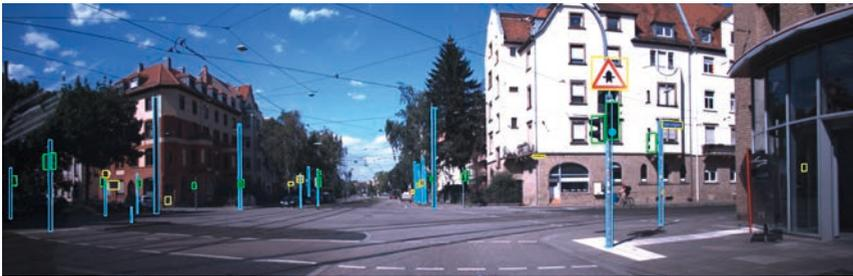
Abbildung 2: Beispielhaftes Kartierungsergebnis an einer urbanen Kreuzung in Karlsruhe. Masten sind in Hellblau, Ampeln in Grün und Schilder in Gelb gezeigt.
