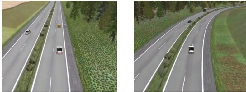
Abbildung 2: Darstellung der Simulation der Systemgrenze 1 enge Rechtskurve (rechts) sowie der Systemgrenze 2 Pannenfahrzeug als Hindernis auf der Fahrbahn (links) aus der Vogelperspektive.
