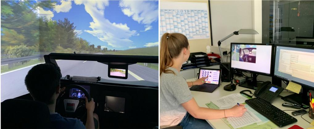
Abbildung 1: Darstellung des Fahrerplatzes des Probanden im Simulator (links) sowie der Versuchsleiterposition im Operatorraum zur Beobachtung des Versuchs (rechts).
