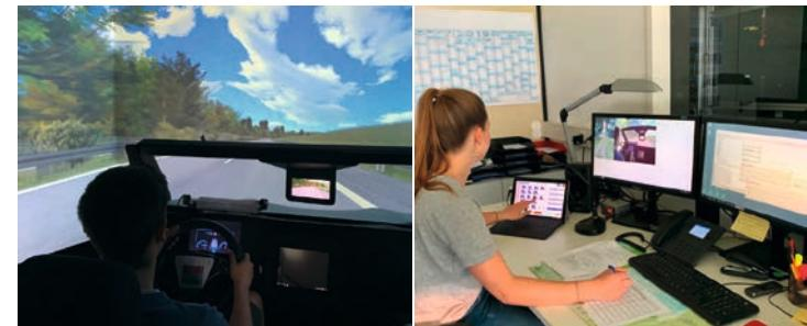
Abbildung 1: Darstellung des Fahrerplatzes des Probanden im Simulator (links) sowie der Versuchsleiterposition im Operatorraum zur Beobachtung des Versuchs.
